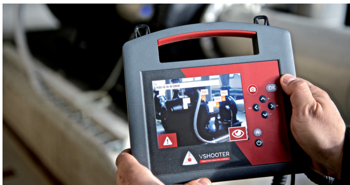
VShooter, analyseur vibratoire avec caméra embarquée.
