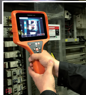
[1] LeakShooter V3+, détecteur de fuites d'air comprimé. [2] TShooter, caméra thermique à détection instantanée de défauts.
