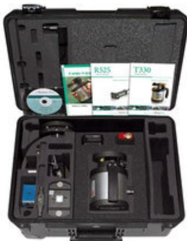
Ensemble de mesure PROLINE 20 avec source laser T330 et détecteur 2 axes R525
