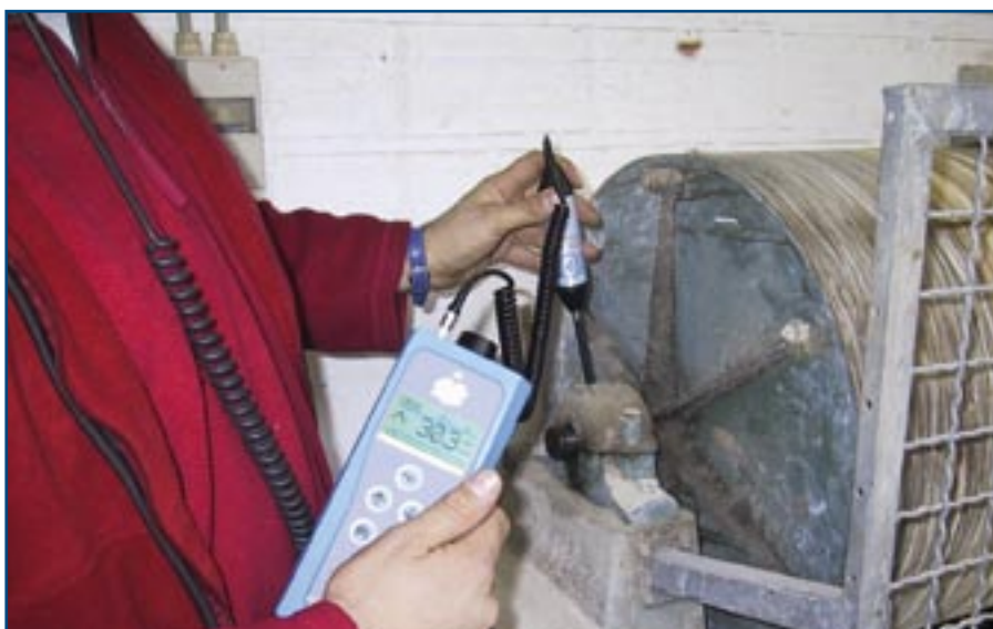
Le contrôle par ultrasons est souvent utilisé pour détecter les défauts spécifiques aux roulements (usure, roulement défectueux, mauvais graissage, etc.). S'il est nécessaire d'aller plus loin et de réaliser un diagnostic approfondi, la méthode laisse alors sa place à l'analyse vibratoire.
